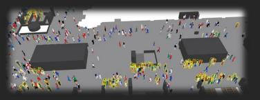
Abbildung von Warteschlangen inklusive Schalterwahl (kleinere Schlangen bevorzugt) und Obergrenze (max. Länge der Schlange) und abgeschätzter durchschnittlicher Dauer
